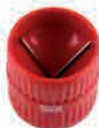
Para avellanar el exterior del tubo
