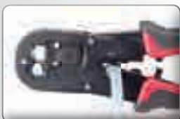
Corte de cables de red
